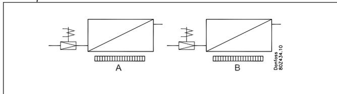
При электрическом оттаивании нагревательные элементы каждой секции регулируются индивидуально.
