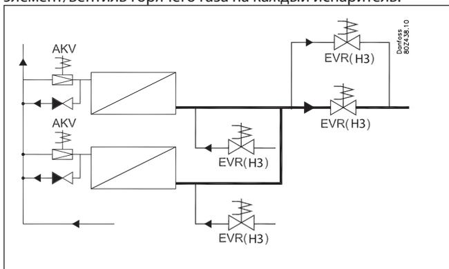
Пример использования оттаивания горячим газом с индивидуальной остановкой для каждого испарителя.
