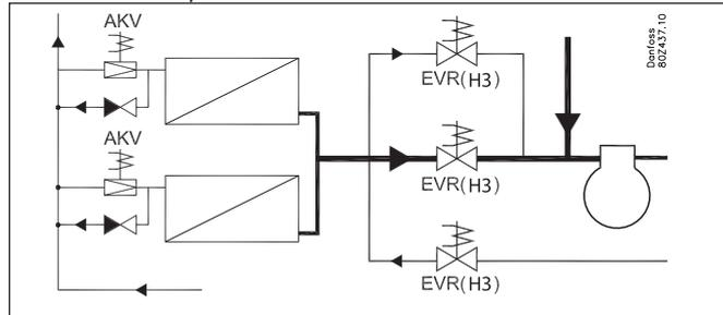
Во время оттаивания горячим газом контроллер управляет вентилями в жидкостной линии, вентилями горячего газа, вентилем линии всасывания и дренажным вентилем.
