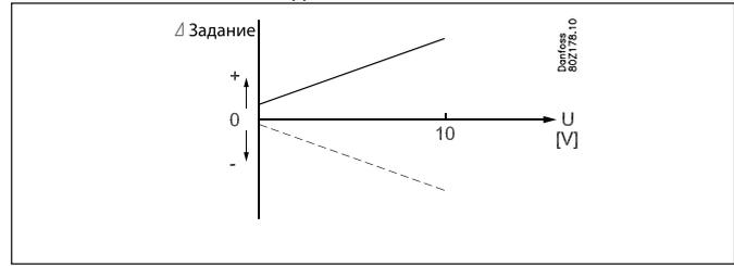
Сигнал напряжения может быть 0–5 В, 0–10 В, 1–5 В или 2–10 В. Обязательно нужно установить две величины смещения: одна — указывающая сдвиг при минимальном сигнале, и вторая, указывающая сдвиг при максимальном сигнале. Это смещение будет применяться ко всем секциям.
