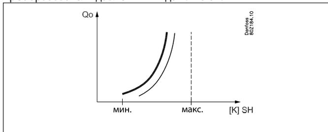
Функция включает адаптивный алгоритм, который регулирует степень открытия вентиля таким образом, чтобы постоянно обеспечивать оптимальное охлаждение при минимально возможном перегреве.
