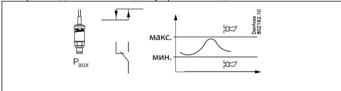
Регулятор давления может использовать или один из датчиков, используемых в управлении (Po, Pc), или независимый датчик (Paux1, Paux2, Paux3).
