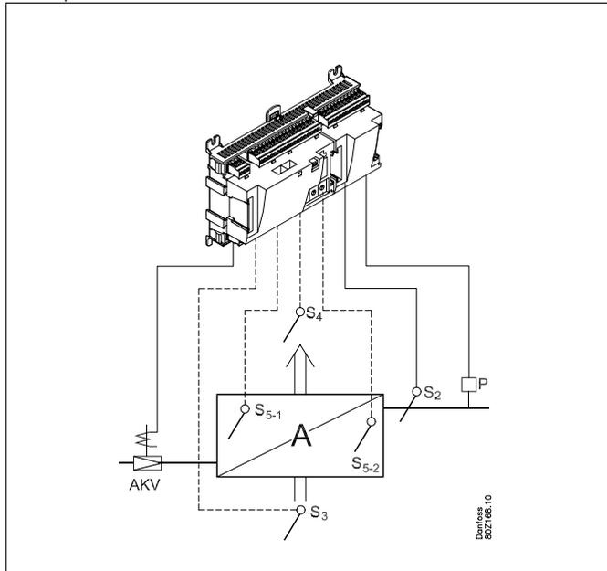
Основной функцией контроллера является управление испарителем таким образом, чтобы система постоянно работала в наиболее энергетически выгодном режиме охлаждения. Уникальная функция оттаивания по необходимости самостоятельно определяет необходимость оттаивания, адаптируя количество оттаиваний таким образом, чтобы уменьшить затраты энергии на ненужные оттаивания и последующие охлаждение для выхода на режим.
