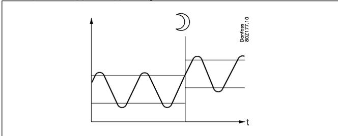
В торговом оборудовании может быть большая разница в нагрузке при работающем магазине и после его закрытия, особенно когда используются ночные крышки/шторки. В этом случае настройка термостата может быть поднята без какого-либо ее влияния на температуру продукта.
