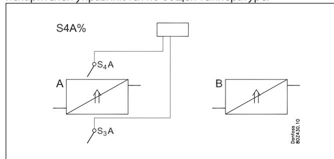
Как альтернатива, температурой термостата может быть минимальное значение, максимальное значение или среднее значение всех датчиков S3 или S4, используемых в секциях. Как правило, такое решение применяется в установках, где один соленоидный вентиль используется для нескольких секций оборудования, там где нужно обеспечить, чтобы термостат учитывал температуру во всех секциях.
