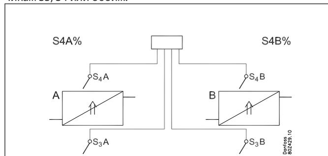
Определение температуры термостата происходит по одной установке, которая базируется на значении S4. При установке 100% используется только S4. При установке 0%, используется только S3. При значении установки между 0 и 100%, используются оба значения.
