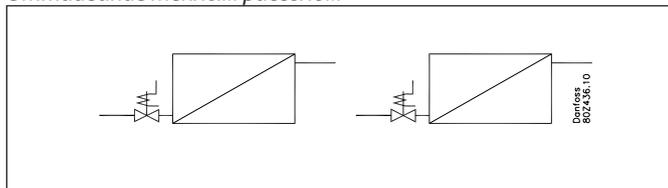
Оттаивание теплым рассолом может использоваться в системах с непрямым охлаждением при помощи соленоидных вентилялей.
