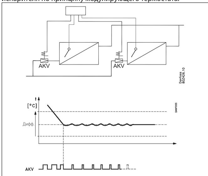
Термостат в каждой секции регулирует температуру по датчикам S3/S4 соответствующей секции.
