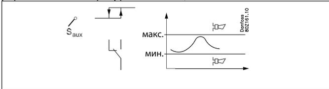
Термостат может использовать как один из датчиков, используемых в управлении (S3, S4), так и независимый датчик (Saux1, Saux2, Saux3, Saux4).
