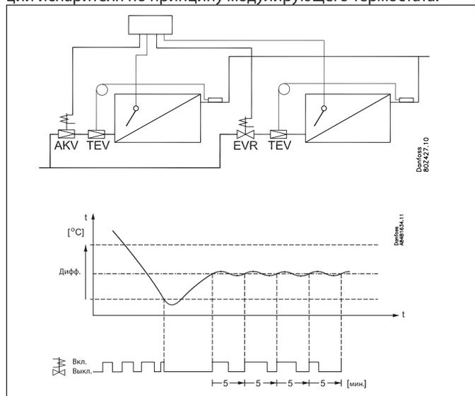
С соленоидными вентилями используется принцип широтно-импульсной модуляции с настраиваемым периодом. Вентиль открывается и закрывается в течение определенного периода (например, 5 мин.). PI – контроллер рассчитывает время вентиля в открытом состоянии, так чтобы поддерживать постоянную температуру.
