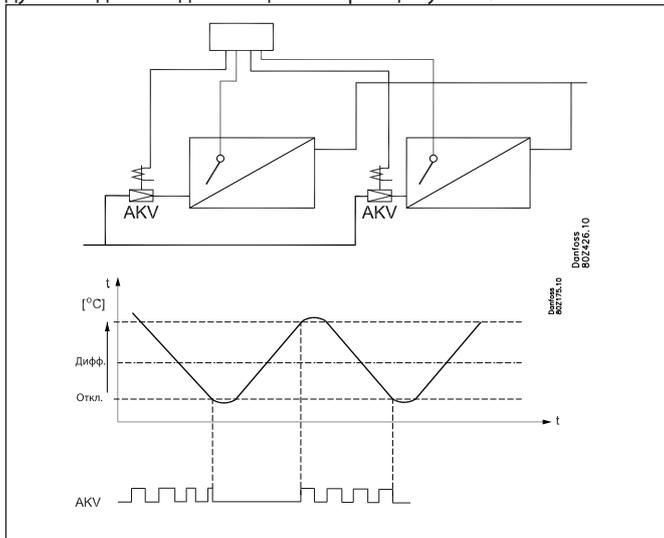
Термостат в каждой секции регулирует температуру по датчикам S3/S4 соответствующей секции.
