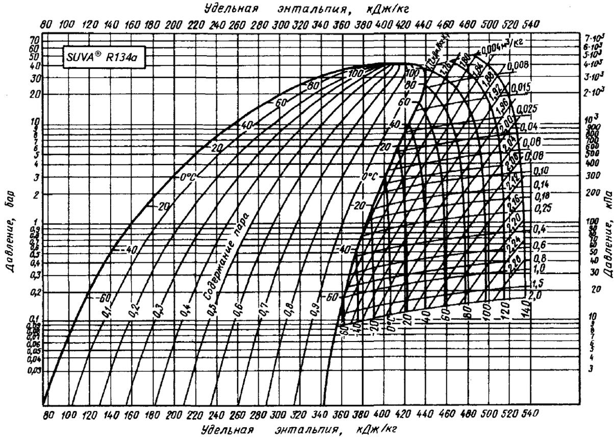
Рис. П1. Диаграмма «удельная энтальпия — давление» для SUVA®R134a
