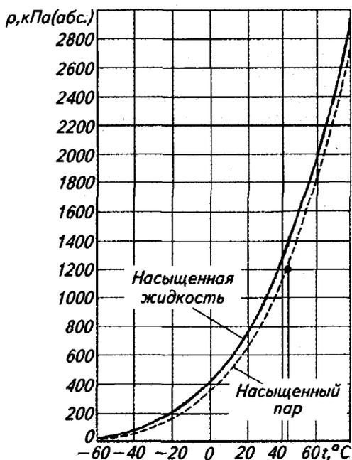
Рис. 8. Зависимость давления насыщения от температуры для R401B
