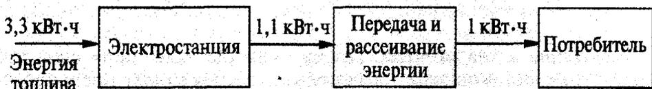
Рис. 1. Потери энергии при ее транспортировке потребителю
