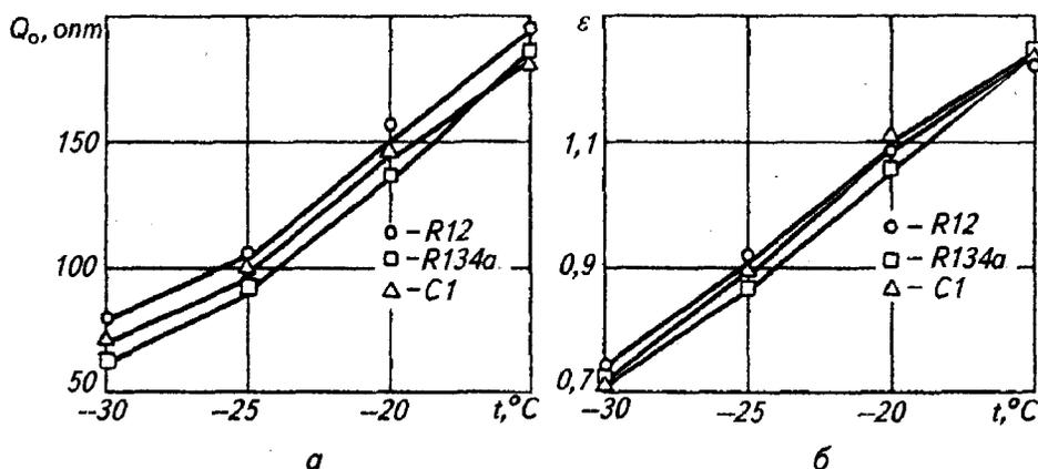
Рис. 5. Зависимость холодопроизводительности  $Q_0$  (а) и холодильного коэффициента  $\epsilon$  (б) от температуры кипения при работе компрессора V1040G на хладагентах R12, R134a и C1 при температуре конденсации  $55^\circ\text{C}$  и всасывания  $32^\circ\text{C}$
