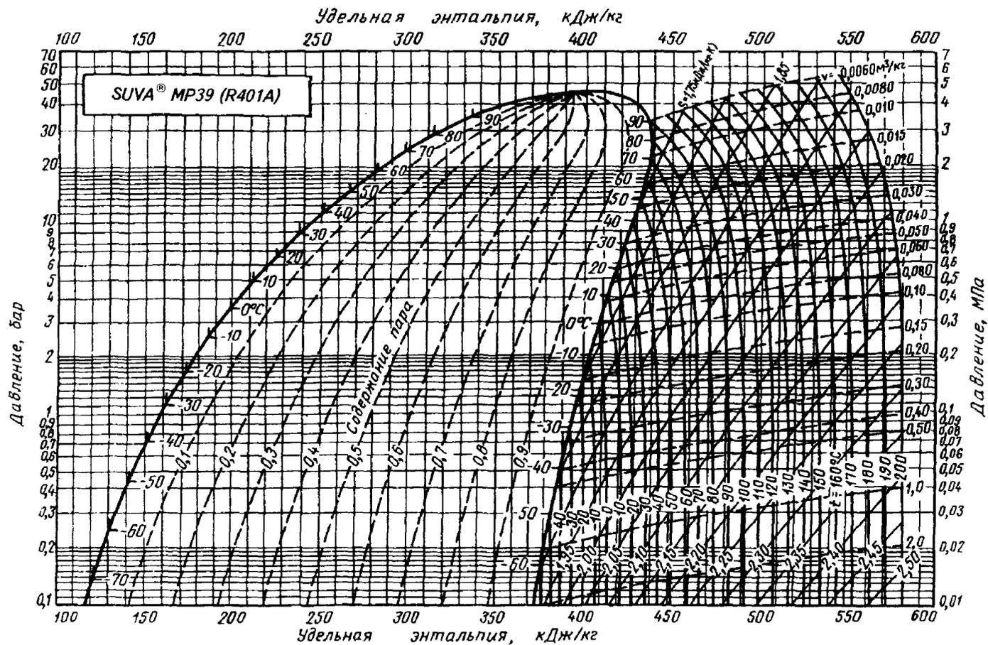
Рис. П3. Диаграмма «удельная энтальпия — давление» для SUVA®MP39 (R401A)
