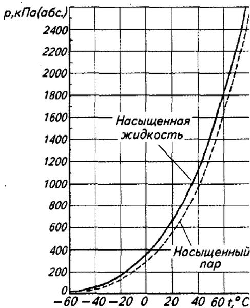
Рис. 7. Зависимость давления насыщения от температуры для R401A
