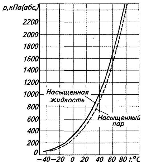
Рис. 9. Зависимость давления от температуры для R401C
