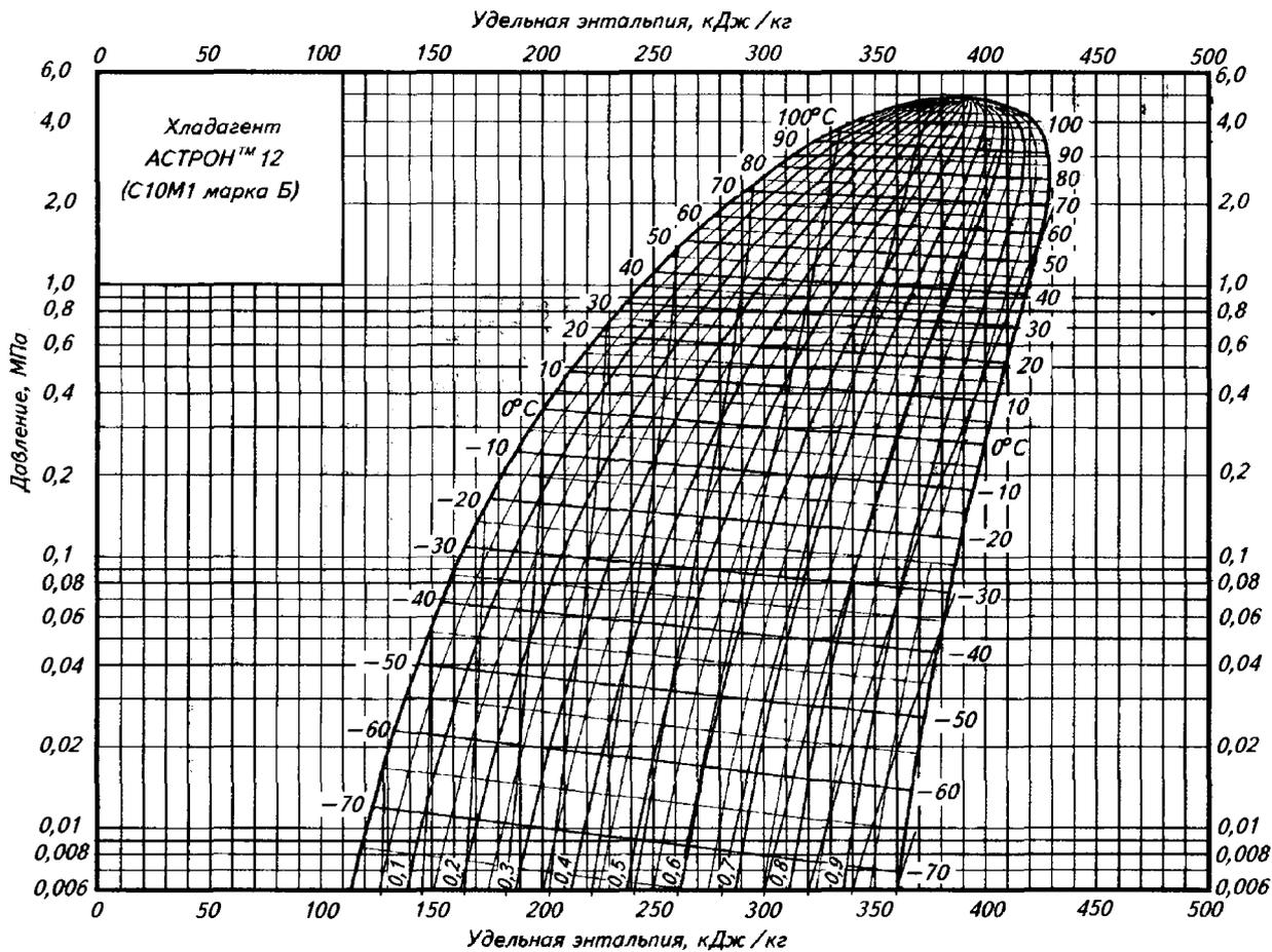
Рис. П4. Диаграмма «удельная энтальпия — давление» для хладагента АСТРОН™12 (С10М1 марки Б)
