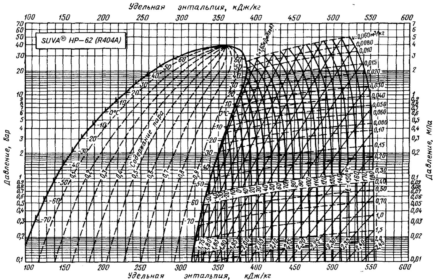
Рис. П2. Диаграмма «удельная энтальпия — давление» для SUVA®HP-62 (R404A)
