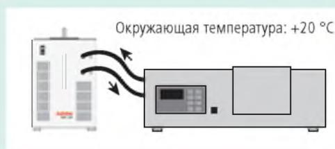
AWC100 предназначен для охлаждения закрытых систем. Прибор непрерывно отводит тепло из протекающей через него охлаждающей воды.
