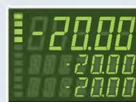
Все значения температур на экране: Большой дисплей одновременно отображает до трех значений температур:
