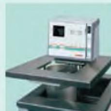
Камера термостатирования с равномерным переливом
