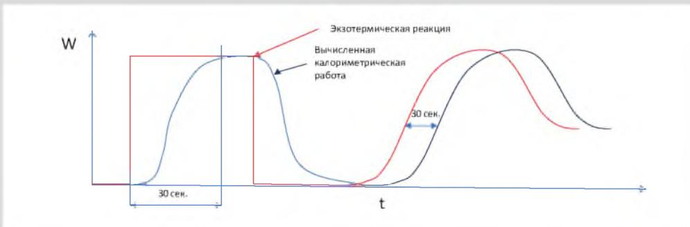
Кривая времени при измерении с VFCpro-24 и PRESTO®. Динамическая составляющая ошибки обусловлена фильтрованием измеряемых значений.
