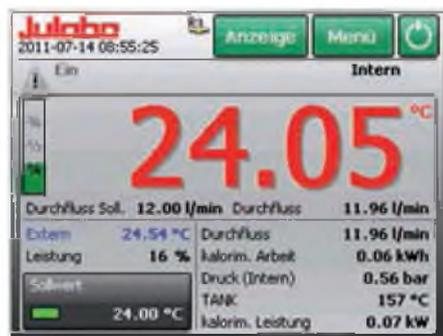
Измеренная через VFCpro скорость потока, а также рассчитанные PRESTO® калориметрические параметры отображаются напрямую на дисплее PRESTO®.
